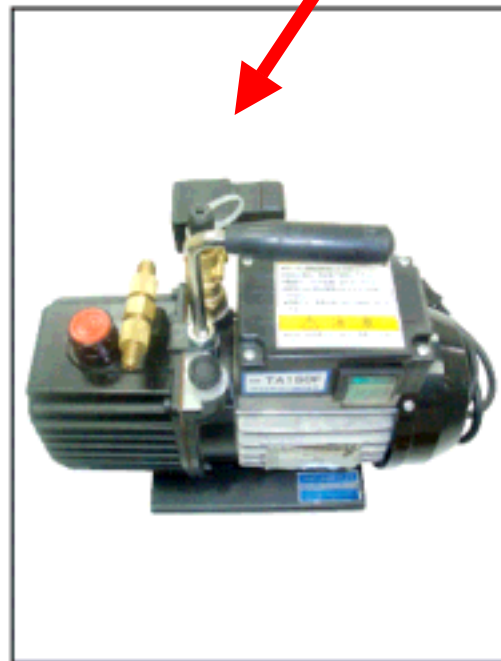
真空泵浦： 為管路抽真空使用。
